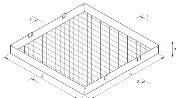
Общий вид панели MESH HOOK-ON 300
